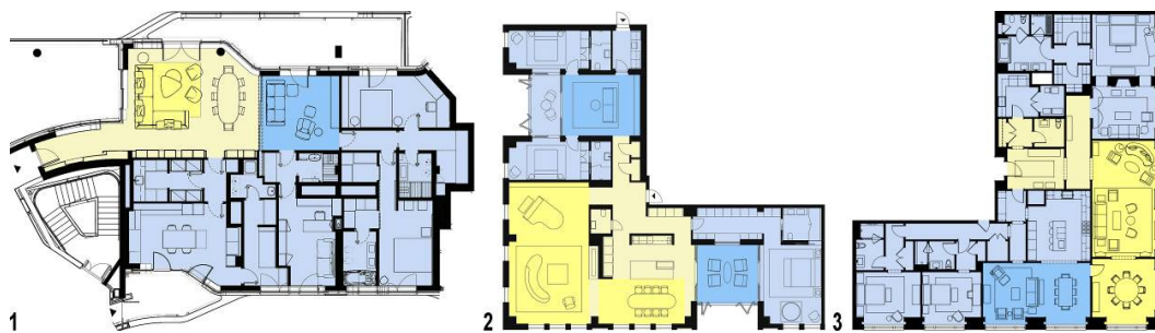
Sl. 3 Karakteristični primeri stambenih prostora sa fleksibilnim centrom na granici između zona: 1) Citylife Residential Complex, Milano (Zaha Hadid Architects, 2016); 2) Karlatornet, Gothenburg (Skidmore, Owings & Merrill, 2019); 3) 900 North Avenue, Chicago (Kohn Pedersen Fox Associates, 1989). (Izvor: arhiva autora)
